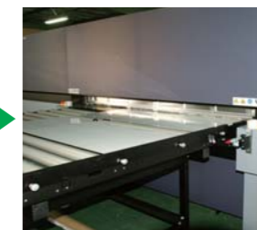
板をセット。鉄板やアルポリ板、PP板に直接印刷します
