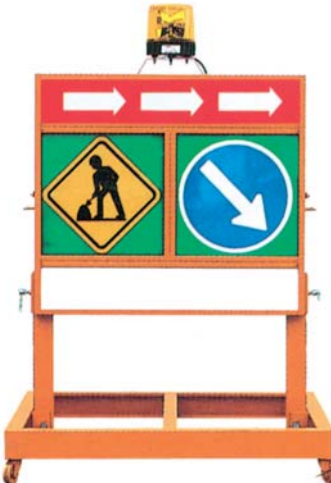
GE-57 (GE-1200) サイズ: W1,121×H1,527×D900mm 矢印板: 195×990mm 中央板: 490×490mm 190×990mm 重量: 約43kg
